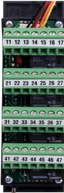
Auf der Steuerkarte befinden sich bis zu 4 Taster, die potenzialfreie Relaisausgänge ansteuern. Zur Signalisierung der Rückmeldung vom Leistungsschutz sind grüne Leuchtdioden eingebaut. Für Störmeldungen stehen rote LED's zur Verfügung, die bei Ansteuerung auf dem Zentralmodul RSM eine Sammelstörmeldung erzeugen. Die LED's werden mit +24V DC angesteuert. Mit dem potenzialfreien Wechsler je Steuereinheit können Leistungsschütze direkt geschaltet werden (Kontaktbelastung beachten).
