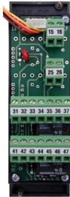
Die Steuerkarte RLK.... dient als Handbedienebene mit Notfunktion zur Ansteuerung von ein bis zwei 2-stufigen Motoren.
