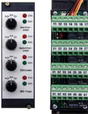
Die Steuerkarte RPK... dient als Handbedienebene mit Notfunktion zur Ansteuerung von ein bis vier 1-stufigen Motoren.
