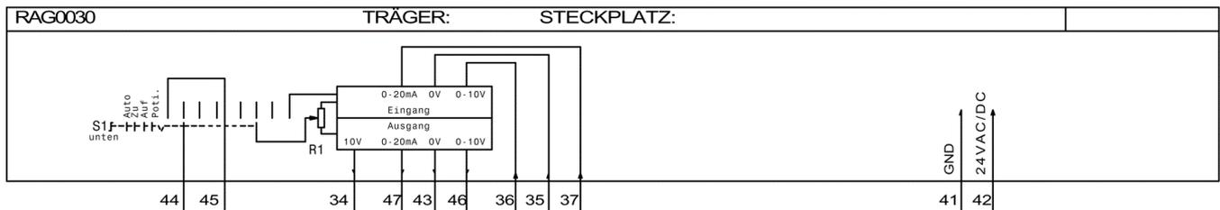
Spannungsversorgung 24V AC/DC, ±10%
