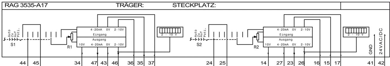
Spannungsversorgung 24V AC/DC, ±10%
