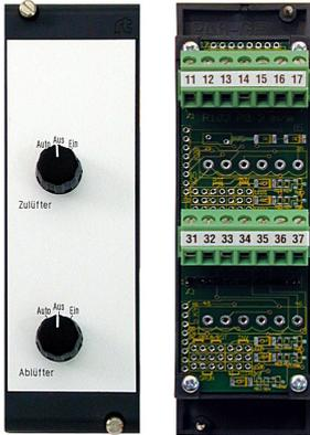
Die Schalter-Karte RSL0x0x dient zum Schalten von Relais und Schützen bis 230V (Übersteuerung des Automatiksignals).
