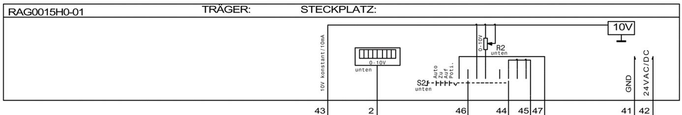
Spannungsversorgung 24V AC/DC, ±10%
