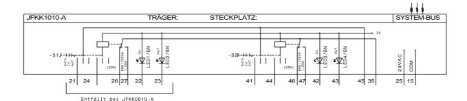
Versorgungsspannung: 24 VAC, ±10% Stromaufnahme: max. 100 mA
