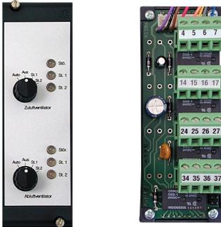
Die Karte BDH 2200 dient als Handbedienebene mit Notfunktion zur Ansteuerung von zwei 2-stufigen Motoren (Auto-Aus-Stufe1-Stufe2) bzw. Klappen (3-Punktsteuerung, Auto-Halt-Auf-Zu). Die beiden Kanäle verfügen über je zwei Relaisausgänge (Wechsler) zur Ansteuerung von Leistungsschützen sowie über drei LEDs zur Signalisierung von Stör-, Betriebs- oder Statusmeldungen.
