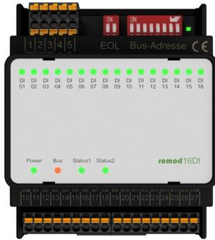
Das Digital-Eingangs-Modul romod 16 DI dient zur Aufschaltung und Signalisierung von bis zu 16 Meldungen. Dazu zählen Betriebsmeldungen, Störmeldungen wie Frost, Filter oder Keilriemen sowie Statusmeldungen wie z.B. Klappenstellungen.
