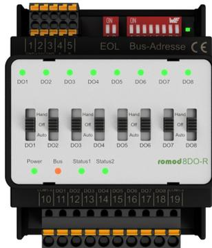
Das Digital-Ausgangs-Modul romod 8 DO-R dient zur Ansteuerung von acht 1-stufigen Antrieben o.ä. Es bietet die Möglichkeit, die über den Modbus empfangenen Schaltbefehle für die DOs mit Hilfe der Schalter manuell zu übersteuern und somit eine sog. lokale Vorrangbedienug (LVB) zu realisieren.
