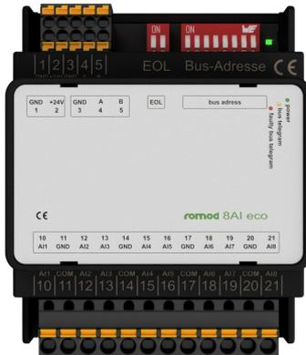
Das Analog-Eingangs-Modul romod 8 AI eco dient zur Aufschaltung von bis zu acht analogen Fühlerwerten. Die Aufschaltung auf das Modul erfolgt über abziehbare Klemmen.
