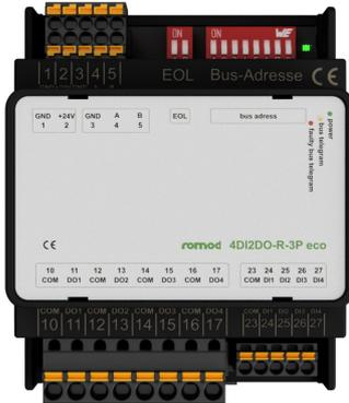
Das Modul romod 4DI2DO-R-3P eco verfügt über 2x 3-Punkt-Relaisausgänge in zwei Gruppen, zur Ansteuerung von 2 AUF-STOP-ZU-Antrieben o.ä. Die vier digitalen Eingänge können z.B. für Betriebs- oder Statusmeldungen genutzt werden.
