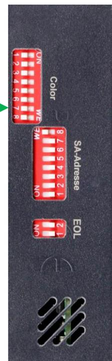
Befindet sich der DIP-Schalter in der ON-Position, dann wird die LED rot leuchten, in der Stellung OFF dagegen grün.
